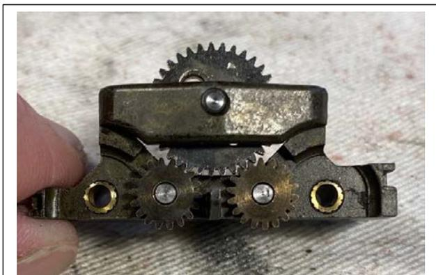
図15 - 新しいギアの取り付け
