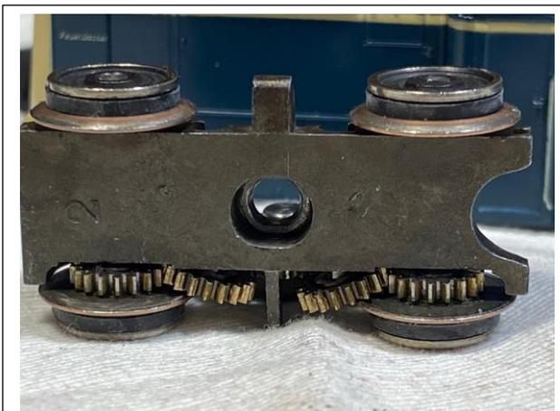
図13 - 台車の摩耗したギア
