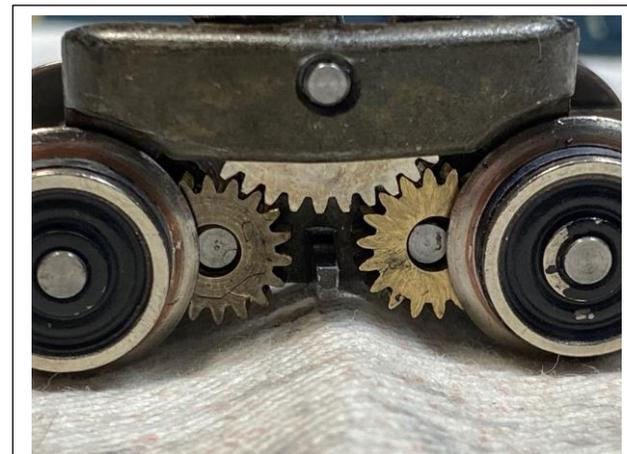
図14 - 台車の摩耗したギア
