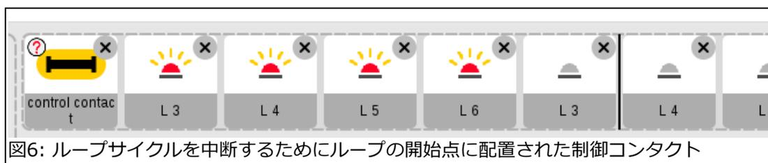
図6: ループサイクルを中断するためにループの開始点に配置された制御コンタクト
