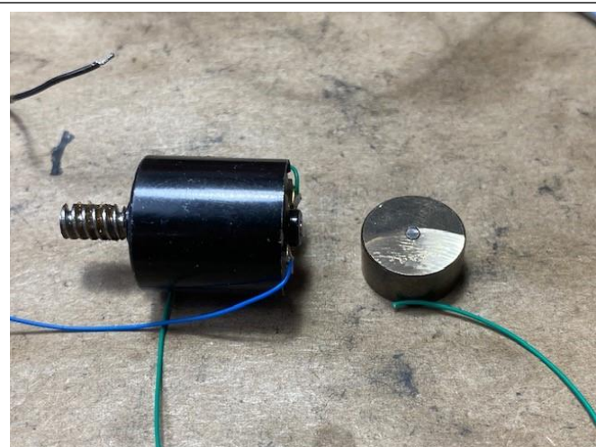
図7 - フライホイールの切断。
