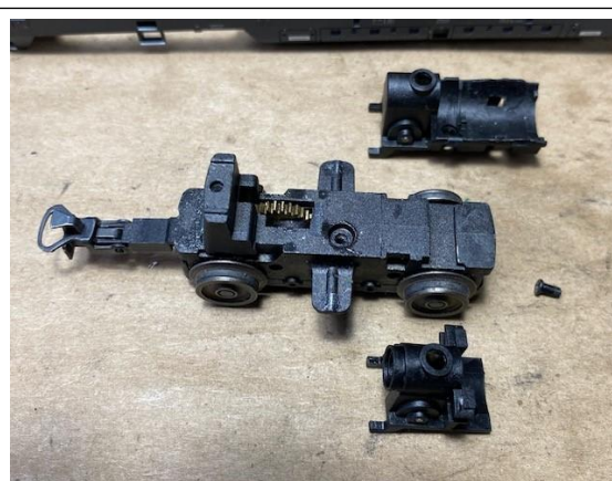
図3 - 古いモーターサドル(上)と新しいモーターマウント(下)。
