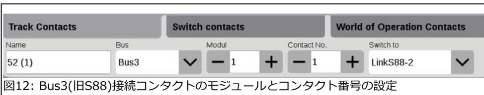
図12: Bus3(旧S88)接続コンタクトのモジュールとコンタクト番号の設定
