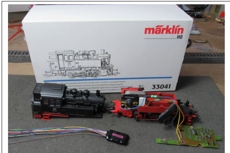
図4 - デコーダーと機関車の取り付け準備完了。
