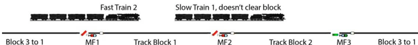
図6. 列車1は、列車2が進入するブロックをクリアするのに十分な速度ではありません
