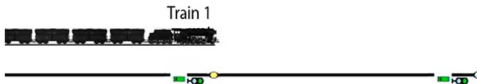
図9. 列車がコンタクトレール上にとどまると、s88は変化なし
