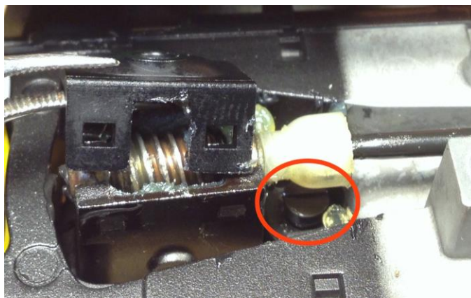
図8 ウォームギアキャップを取り外します。赤丸は緩みやすいネジです
