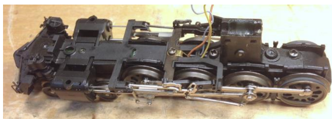
図10 前側台枠アセンブリの取り外し
