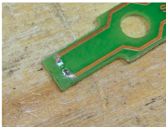
図17 LEDを取り外し、ワニスを削り銅箔を露出させました
