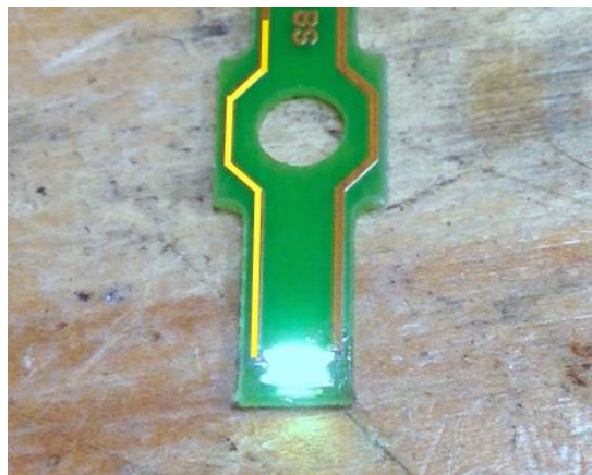
図18 所定の位置にハンダ付けされ、テスト中の新しいLED
