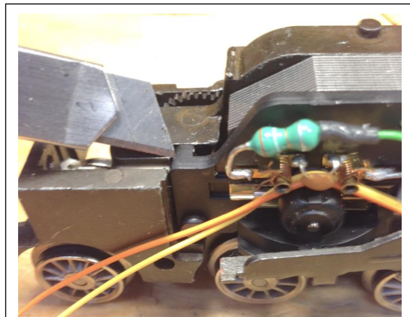
図11 - 後部ライト用配線がきれいに通らない!
