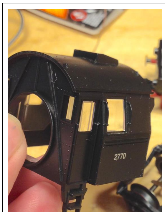
図2 - 窓の塗装を剥離し磨きました
