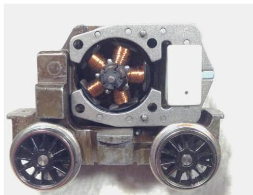
図11 - 取り付けられた界磁と電機子
