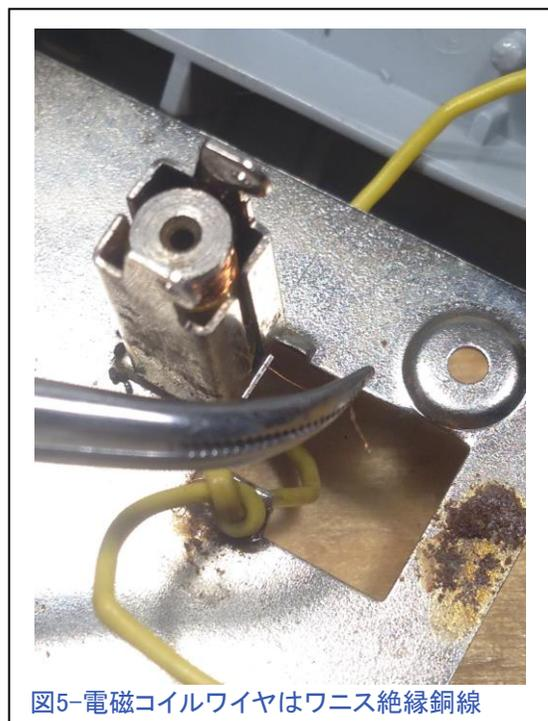
図5-電磁コイルワイヤはワニス絶縁銅線
