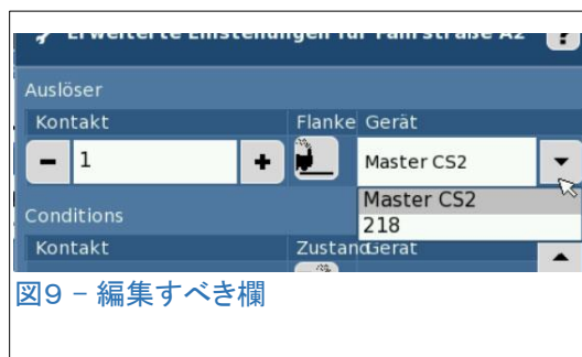
図8 - “Ext.”設定パネルで“Gerat(デバイス)”を設定する
