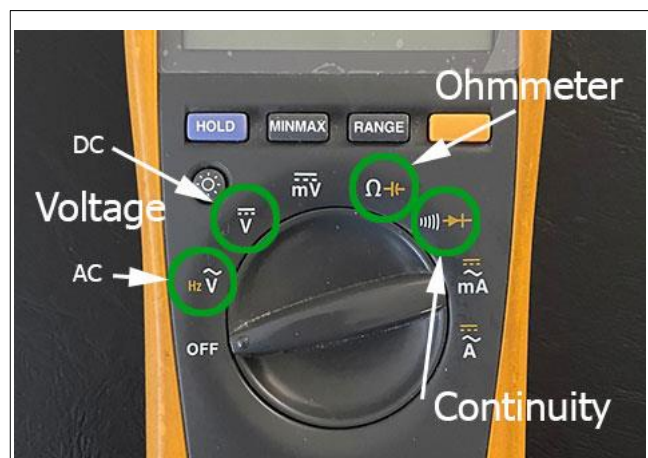
図1：DMMで使用される主なモード (左から)AC電圧、DC電圧、抵抗値、導通
