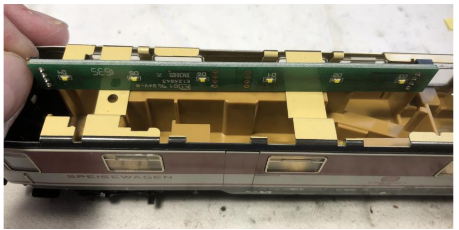
図9 LEDと梁とのクリアランスの確認。
